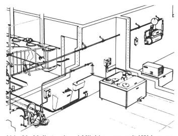
Abb. 29: Melkstand und Milchkammer mit Kühlwanne sowie getrenntem Maschinenraum.
