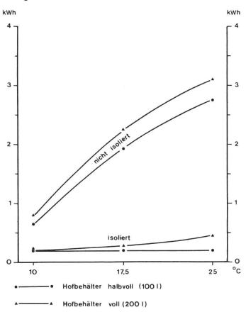
Abb. 26: Einfluss der Isolation auf den Energieverbauch.
