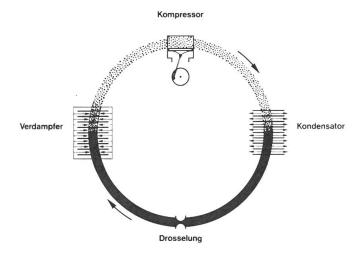
Abb. 3: Kreislauf des Kältemittels in einer Kühlanlage.
