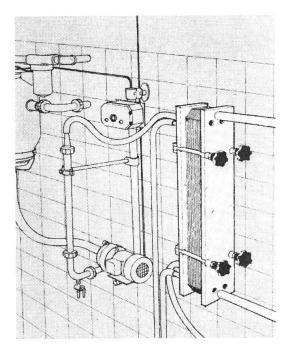
Abb. 8: Plattenkühler in Verbindung mit Rohrmelkanlage.
