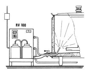
Abb. 23: Automatische Tankreinigung über den Auslaufstutzen.
