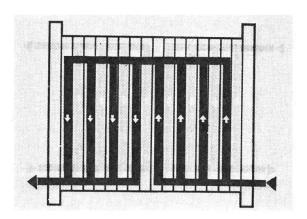
Abb. 7: Plattenkühler.
