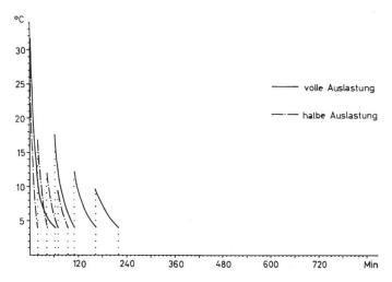
Abb. 10: Kühlkurven (4 Gemelke) indirekte Kühlung, grosser Eisvorrat.
