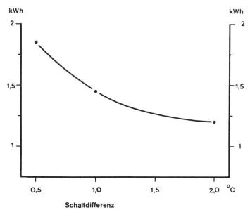
Abb. 25: Einfluss der Schaltdifferenz auf den Energieverbrauch.
