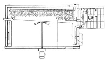
Abb. 16: Kühlwanne mit Eiswasserberieselung.
