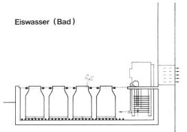
Abb. 13: Eiswasserbecken mit aufgesetztem Kühlaggregat.
