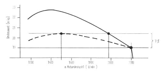
Steigt der Zugkraftbedarf bei voller Belastung um 7 % an, (z.B. durch grössere Steigung der Strasse) fällt die Drehzahl (und damit auch die Geschwindigkeit) von Iraktor Nr. ] auf 2000 U/min und von Iraktor Nr. 2 auf 1500 U/min.
