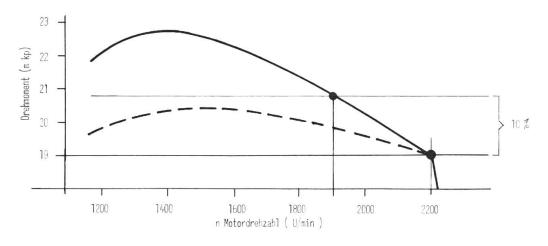
Steigt der Zugkraftbedarf um 10 % an, fällt die Drehzahl von Traktor Nr. 1 auf 1900 U/min zurück. Traktor Nr. 2 kann diese Spitze nicht mehr überwinden; Es muss herabgeschaltet werden, da sonst der Motor abgewürgt wird!
