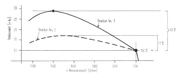
Beide Traktoren haben gleiche maximale Leistung und damit das gleiche Drehmoment bei Nenndrehzahl (2200 U/min) Traktor Nr. 1 hat einen Drehmomentanstieg von 19 %, Traktor Nr. 2 jedoch nur 7 %.
