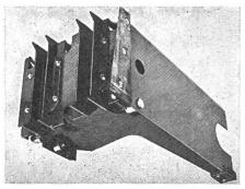
Mit einer Hublänge von 76 cm und einer Ballen-Frequenz von 80 Hüben pro Minute verdichtet der John Deere-Presskolben mehr Material in jedem Ballen. Er läuft auf 3 staubgeschützten Rollenlagern – sicher und ausserordentlich geräuscharm.
