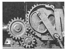
Zahnradgetriebener Knoter. Mehr Zuverlässigkeit bei weniger Wartung, Knotensicher in Plastik und Sisal.
