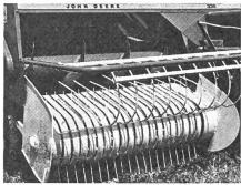
Breite Pick-up mit besonders engem Zinkenabstand für eine rechensaubere Aufnahme. Sie ist 25 cm seitlich versetzt vom Presskanal angeordnet. Dadurch wird vermieden, dass die Traktorreifen über das Schwad
