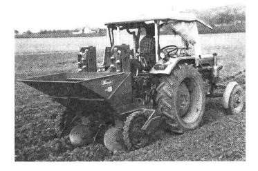
folgt durch eine Bedienungsperson. Zur Vermeidung von Doppelbelegungen der Becher kann eine auf die Ketten wirkende, stufenweise einstellbare Rütteleinrichtung zugeschaltet werden. Die Ablage der Knol-
