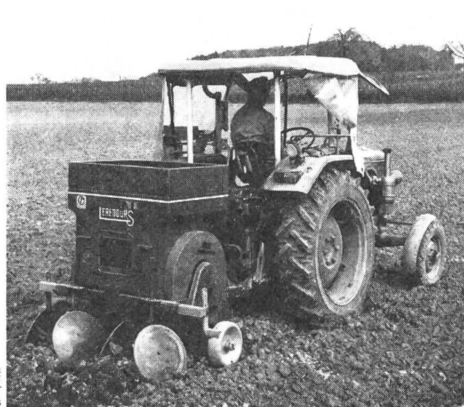
Abb. 3: Links: Greiferscheiben- Kartoffellegeautomat Lerebours R 2. Rechts: Nahaufnahme eines belegten Greifers.
