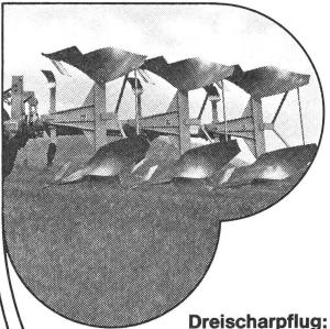
im Baukastensystem, Schnellkupplung, solide und einfache hydraulische Wendung.
