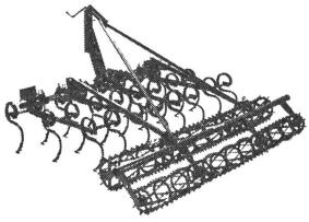
2,2-3,3 m, verschiedene Ausführungen, auch mit Einwalzenkrümler, Block-Chassis, Doppelfederzinken, gleiches Chassis auch für Tiefgrubber verwendbar.
