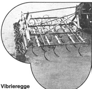
Vibrieregge KOECKERLING: solide Konstruktion, 5 Zinkenreihen, verschiedene Modelle, Krümler im Baukastensystem.
