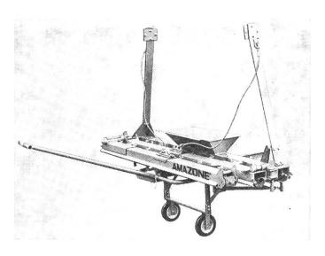
Abb. 1: Der An- und Abbau der Streuschnecke ist durch eine Arbeitskraft leicht möglich: man bedient sich dabei einer einfachen Transportkarre. (Werkfoto)
