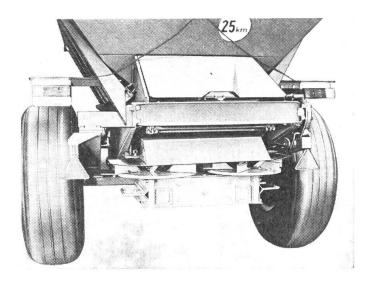
Abb. 2: Das Breitstreuwerk ist in Minutenschnelle leicht an- und abzubauen. Seine beiden Streuscheiben sind gewölbt, mit einer grösseren Anzahl von Schaufeln besetzt und streuen daher über 20 m breit. (Werkfoto)
