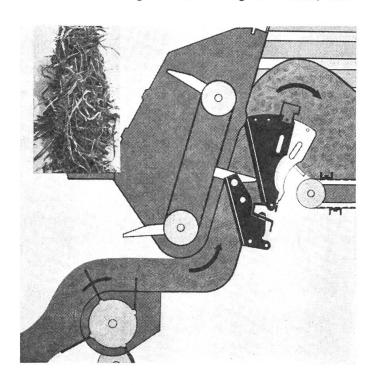
die Messer im ziehenden Schnitt arbeiten. Im übrigen verliert der Mengele-Rechenkettenförderer mit dem Doppel-Silage-Schneidwerk nichts an seiner Leichtzügigkeit.
