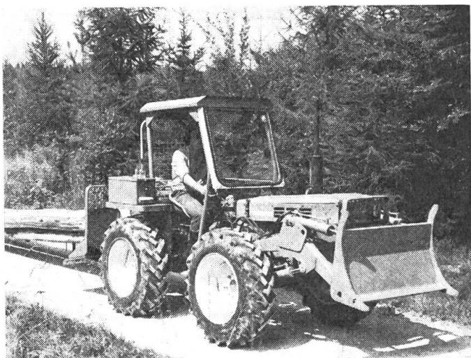
sitz, Holder-Zweizylinder-Hydraulik mit Boschpumpe (16000 N = 1600 kg Hubkraft), Norm-Dreipunktgestänge, 12 Volt-Elektroanlage, Werkzeugkasten mit Werkzeug und Traktormeter.
