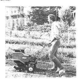
Das Gerät hat eine Arbeitsbreite von 600 mm. Die gewünschte Arbeitstiefe wird bis 250 mm über Stützräder und Bremssporn eingestellt. Der ruhiglaufende 3-PS-Viertaktmotor (2,21 kW) ist mit Normalbenzin zufrieden. Mit der Grundausrüstung wird umgegraben,
