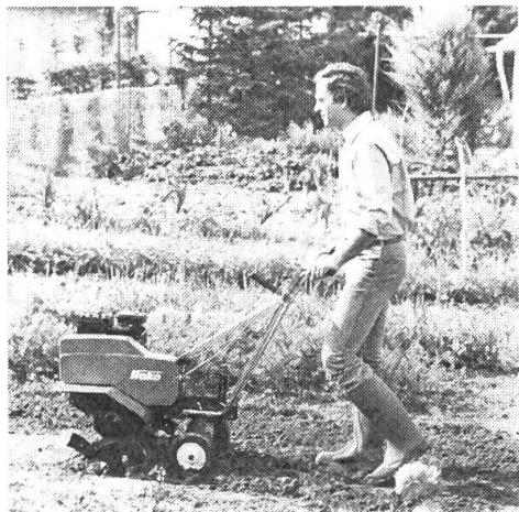
Das Gerät hat eine Arbeitsbreite von 600 mm. Die gewünschte Arbeitstiefe wird bis 250 mm über Stützräder und Bremssporn eingestellt. Der ruhiglaufende 3-PS-Viertaktmotor (2,21 kW) ist mit Normalbenzin zufrieden. Mit der Grundausstattung wird umgegraben,
