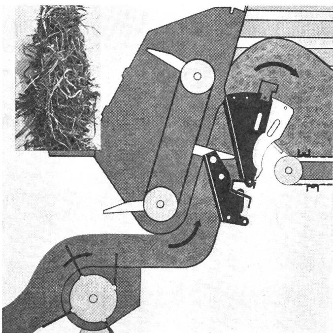
die Messer im ziehenden Schnitt arbeiten. Im übrigen verliert der Mengele-Rechenkettenförderer mit dem Doppel-Silage-Schneidwerk nichts an seiner Leichtzügigkeit.
