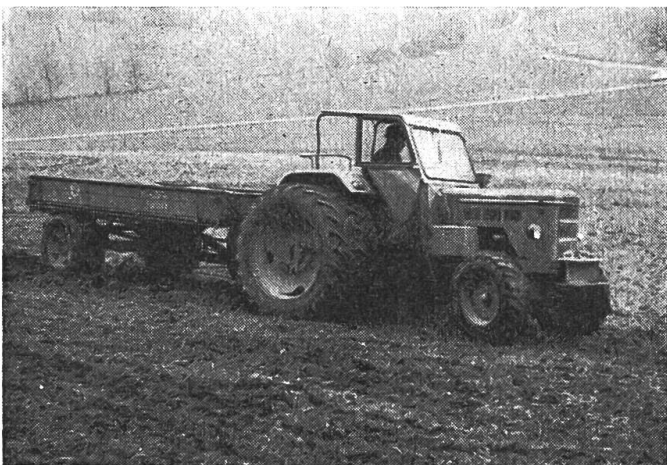
Abb. 2: Traktor und Anhänger mit Doppelbereifung. Am Traktor wurden zusätzlich eine Vorderradbremse und AS-Reifen montiert. Es handelt sich hier um Lastwagenreifen mit Kanten. Reifen neuerer Konstruktion (mit Kanten) würden sich ebenfalls eignen.
