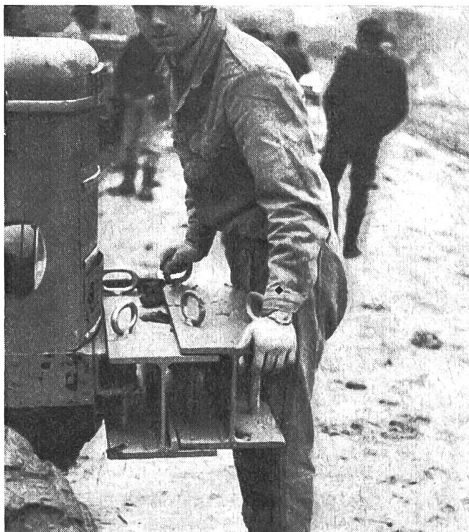
Abb. 1: Aus H-Eisen selbst hergestellte Frontgewichte.
