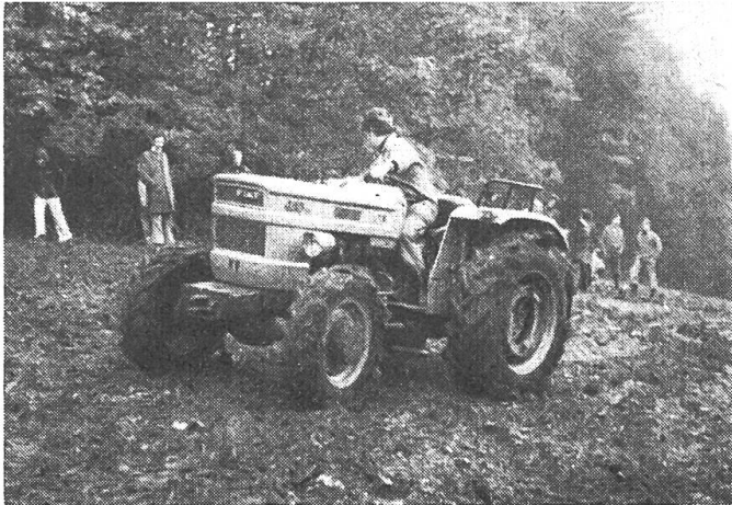
Abb. 3: Das Fahren mit dem Allradtraktor war auf diesem Gelände problemlos. Eine zusätzliche Belastung der Vorderachse wurde durch Frontgewichte bewirkt. (Photos: HR Weiss, Liestal)
