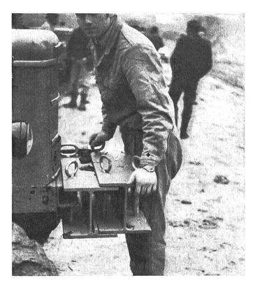
Abb. 1: Aus H-Eisen selbst hergestellte Frontgewichte.
