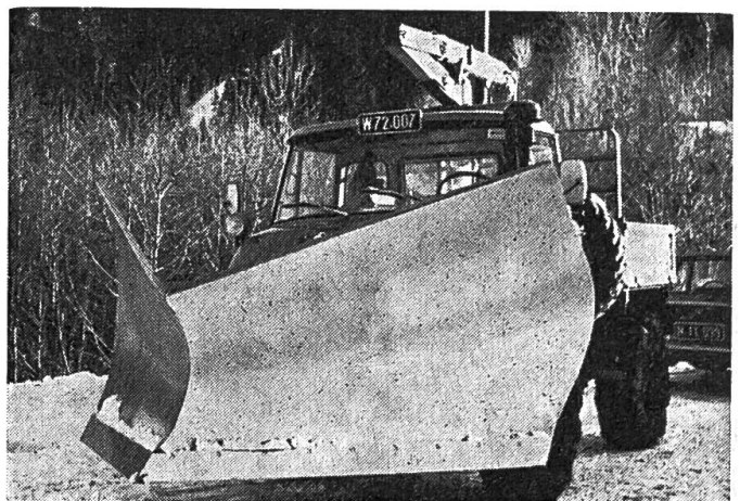
Abb. 3: Der Keilschneepflug für harten Einsatz.
