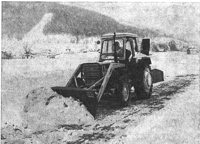
Abb. 2: Kombination von Schneefräse und Frontlader-Schneeräumschild.
