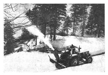
Abb. 4: Eine Schneefräse mit einer Arbeitsbreite von 220 cm.
