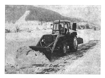
Abb. 2: Kombination von Schneefräse und Frontlader-Schneeräumschild.
