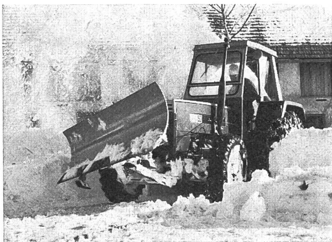
Abb. 1: Das frontseitig angebaute Schneeräumschild.
