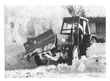
Abb. 1: Das frontseitig angebaute Schneeräumschild.
