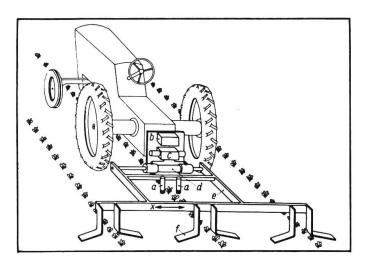
Abb. 6: Anbauhackgerät mit automatischer Nachführung.
