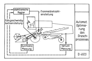
Abb. 8: Automatische Optimierung des Dreschprozesses.
