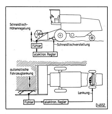
Abb. 4: Automatische Lenkung am Mähdrescher.
