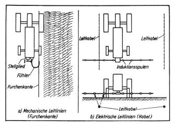
Abb. 3: Leitlinien zur automatischen Steuerung von landw. Traktoren.
