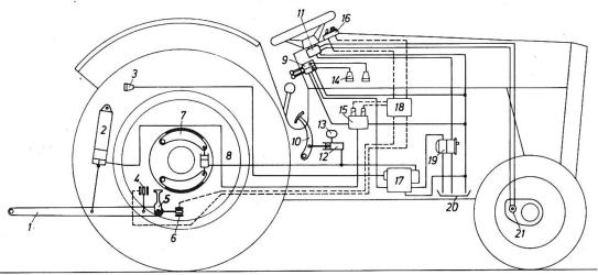
1 Unterlenker 2Hubzylinder 3Kupplung Anhängerbremse 4Geber Lageregelung 5Federstab 6Geber Kraftregelung 7Schlepperbremse 8 Radbremszylinder
