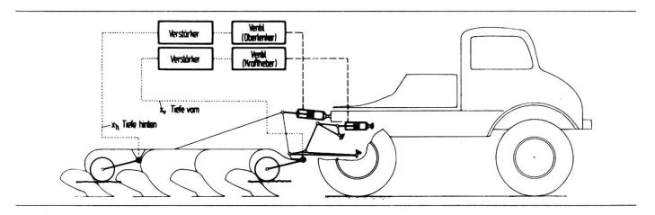
Abb. 7: Elektrohydraulische Zwei-Grössen-Tiefenregelung.
