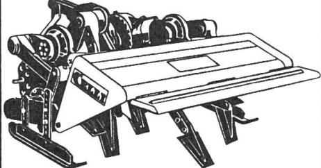
Die neue Celli-Spatenmaschine besitzt ein 4-Gang-Getriebe, das eine flexible Arbeitsgeschwindigkeit erlaubt. Es sind verschiedene Typen erhältlich: mit Arbeitsbreiten von 1.10-2.25 m und mit variablen Arbeitstiefen von 20-40 cm. (3-Punkt-Aufhängung). Keine Furchen und keine Bodenverdichtungen mehr.
