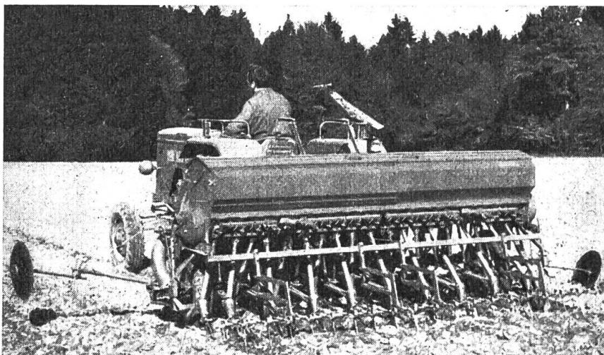
mit **Normal-** oder **Scheibenscharen**, beidseitigem Antrieb, Saatauslauf nach vorne, Pendelrührwerk (Möglichkeit für Raygraseinsätze) usw.
