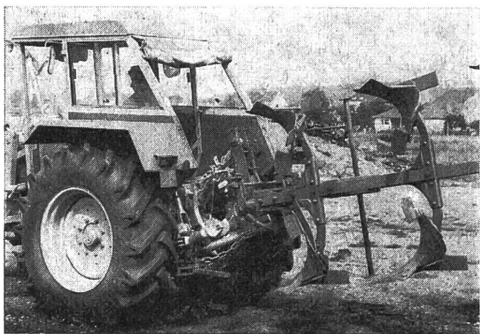
Abb. 2: Mühelos lässt sich ein Dreischarpflug mit dem neuen WKS-Kuppler vom Traktorsitz aus am Traktor anbauen (Foto Walterscheid).
