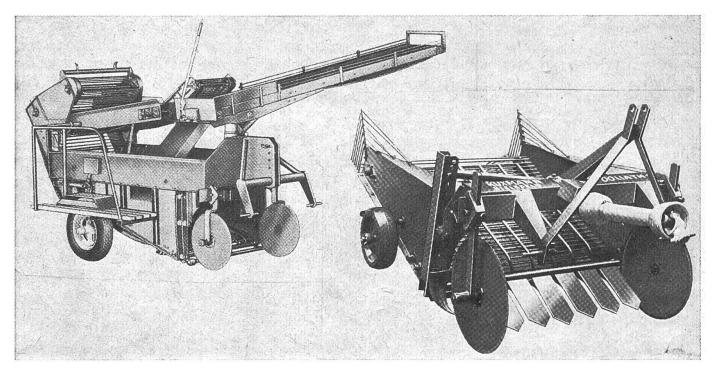
Abb. 5: Kartoffelernte in zwei Etappen? Um die Kartoffeln schalenfester zu machen, damit sie die mechanischen Beanspruchungen während der Ernte besser ertragen, schlägt ein Fabrikant vor, vorerst die Kartoffeln zu roden und an Schwad zu legen und erst nach dem Abtrocknen einzusammeln.
