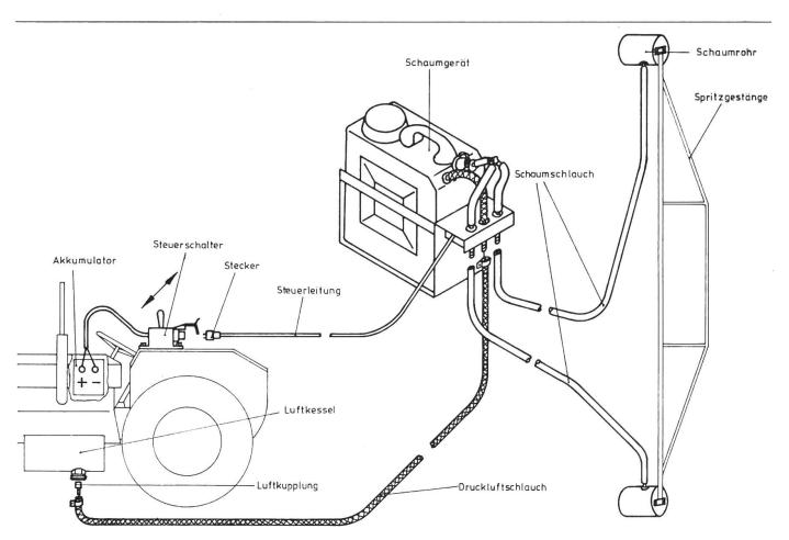
Abb. 4: Schaummarkiergerät erleichtert das Anschlussfahren mit Pflanzenspritzen und Düngerstreuern mit grosser Arbeitsbreite. Ueber einen Kompressor wird eine Flüssigkeit aufgeschäumt und auf dem Feld in Abständen gut sichtbar ausgebracht.
