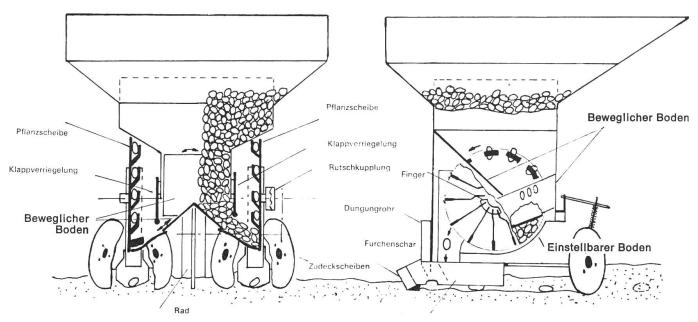
Abb. 3: Kartoffellegegerät, das sich auch zum Pflanzen von vorgekeimtem Saatgut eignen soll. Anstelle der bekannten Becherketten übernimmt ein Förderrad mit Klemmfingern den Knollentransport.
