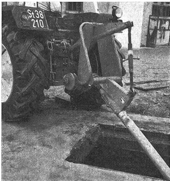
Abb. 1: Die Zapfwelle kann je nach Schaltmöglichkeit und Auslegung verschieden eingesetzt werden, so z. B. zum Güllemixen. Bei diesem Einsatz sind verschiedene Drehzahlen und Drehrichtungen vorteilhaft. Bei Geräten mit hohem Leistungsbedarf ist aber mindestens die Normdrehzahl einzuhalten (540 U/min).
