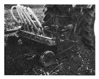
Abb. 1: Mit diesem Güllegrubber wird die Gülle mit spitzen Grubberscharen regelrecht in den Boden injiziert. Vorweg laufen die Tiefenregulierer und ein Scheibensech zum Ziehen der Güllerinne.
