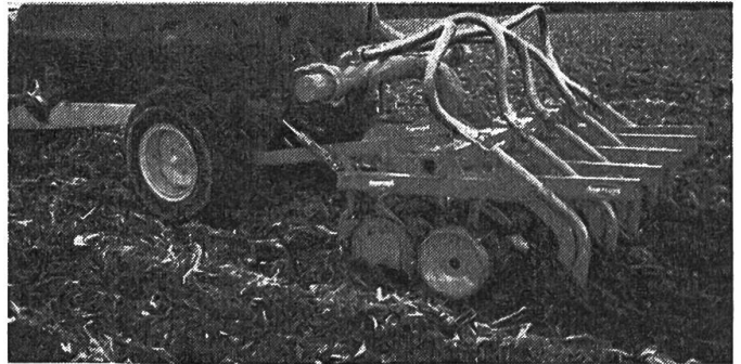
Abb. 2: Mit dieser Kombination von Bodenfräse und Gülleverteiler können grosse Güllemengen gleichmässig verteilt in den Boden eingebracht werden. Die Gülle wird per Schlauch aus einem nebenherfahrenden Tankwagen oder aus einem auf dem Traktor aufgesattelten Tank zu den Verteilrohren gepumpt.
