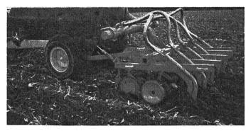
Abb. 2: Mit dieser Kombination von Bodenfräse und Gülleverteiler können grosse Güllemengen gleichmässig verteilt in den Boden eingebracht werden. Die Gülle wird per Schlauch aus einem nebenherfahrenden Tankwagen oder aus einem auf dem Traktor aufgesattelten Tank zu den Verteilrohren gepumpt.
