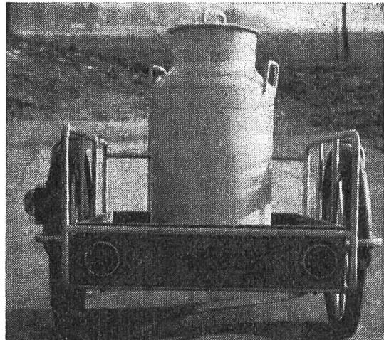
Beispiel einer Kennzeichnung und Beleuchtung (von hinten gesehen) für Milchkarren. Die runden (roten) Rückstrahler sind gut sichtbar. Das gelbe Licht ist seitlich links angebracht, leider weniger gut sichtbar.
