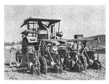
Abb. 31: Mais-Einzelkornsaat mit gleichzeitiger Ausbringung von Insektizid-Granulat. Das Granulat wird nahe an die Maiskörner abgelegt. (Einsatzversuch mit zwei verschiedenen Granulatstreuern.)
