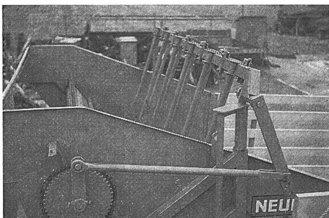
Bei diesem Fabrikat wird das überschüssige Futter durch die hin- und herpendelnde Bewegung eines Rechens wieder in den Zuführteil zurückgeworfen.
