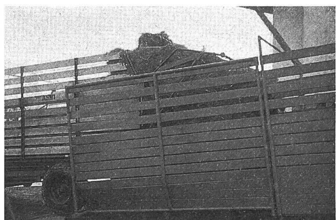
Ein genügend grosser Zuführteil ist von Vorteil, weil sich das locker abgeladene Futter leichter und futterschonender dosieren lässt. Ausschwenkbare Seitensteile helfen mit, dass mit dem Ladewagen nicht allzu genau rückwärts heranmanövriert werden muss.
