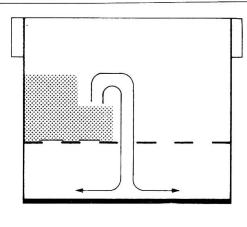
Abb. 7: Viele Luken in der Decke des Futtertenns (Mindestgrösse 1 m x 1 m) verkürzen die Transportwege. Die Arbeit wird dadurch beschleunigt und erleichtert.
