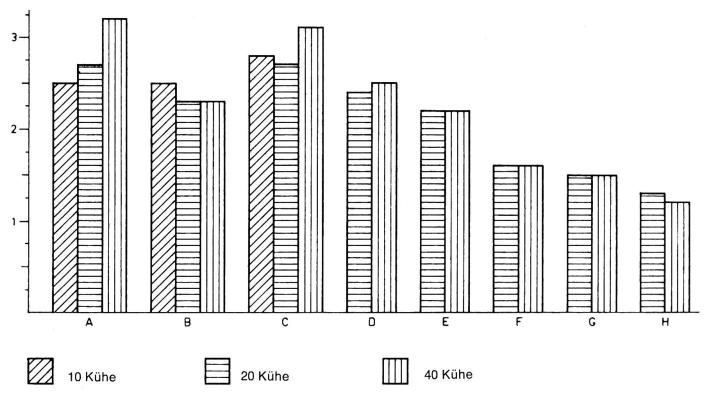
Abb. 10: Arbeitszeitbedarf verschiedener Verfahren für das Füttern einer Kuh (15 kg Heu je Kuh und Tag) in drei Bestandesgrössen.
