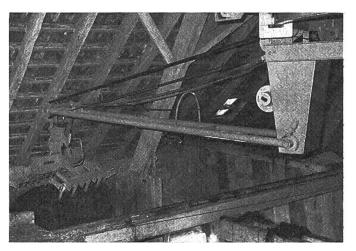
Abb. 9: Drehgreifer in einer «Fuderaufzug»-Scheune.
