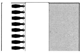
Abb. 1: Einreihige Aufstallung, ebenerdiger Heustock längsseits des Futtertenns.
