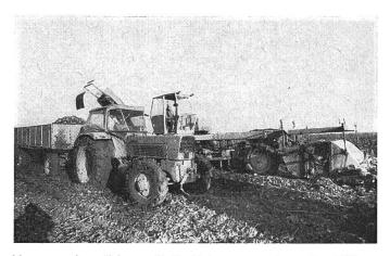
Vom sechsreihigen Selbstfahrer werden die Rüben auf nebenherfahrende Wagen (man kann auch Einachs-Hitchkarren einsetzen) gefördert und zur Feldrandmiete oder sofort zur Zuckerfabrik gefahren. Falls die Witterung günstig ist und die Organisation des Rübenabfahrens klappt, können Stundenleistungen bis zu 1 ha erreicht werden. Foto: Dr. W. Schiffer
