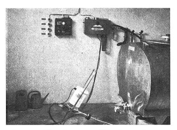
Abb. 4: Die Milchkühlung im Kühltank. Für die Reinigung des Kühltanks kann der Reinigungsautomat eingesetzt werden.
