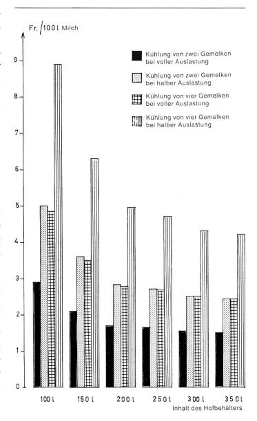
Abb. 7: Kühlkosten bei Hofbehältern mit Tauchkühler pro 100 I Milch. Kühlung von zwei und vier Gemelken bei voller und halber Auslastung.
