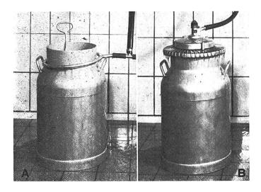
Abb. 2: Die Milchkühlung mit natürlicher Kälte. A Kannenring, B Kannenkühler.
