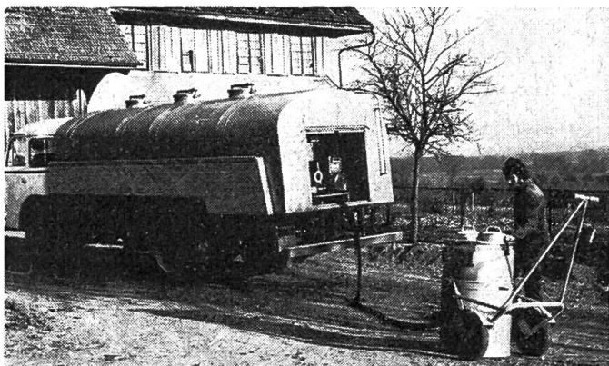
Abb. 1: Die Milch wird nur einmal pro Tag bzw. pro zwei Tage abgeholt. Um das Abholen zu erleichtern, kann der Milchproduzent den Hofbehälter auf ein Fahrgestell bringen und bis zur Strasse fahren.
