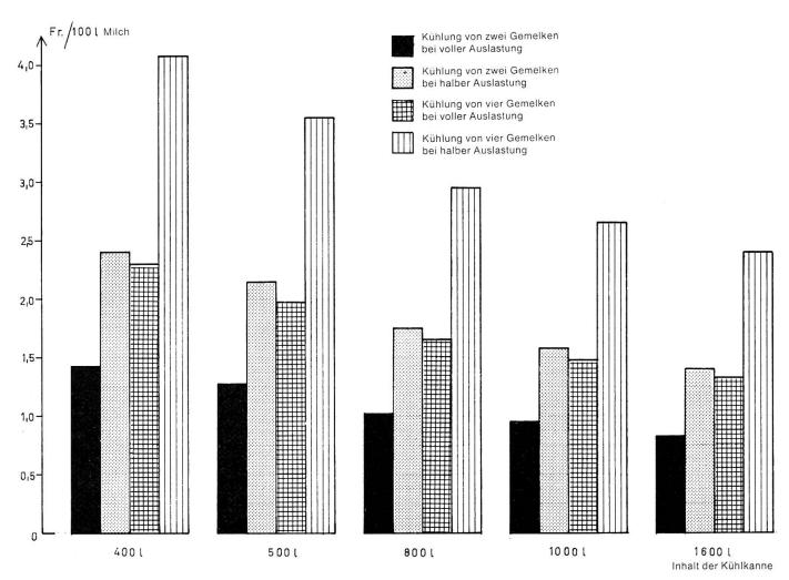
Abb. 6: Kühlkosten der Kühlwanne pro 100 I Milch. Kühlung von zwei und vier Gemelken bei voller und halber Auslastung.
