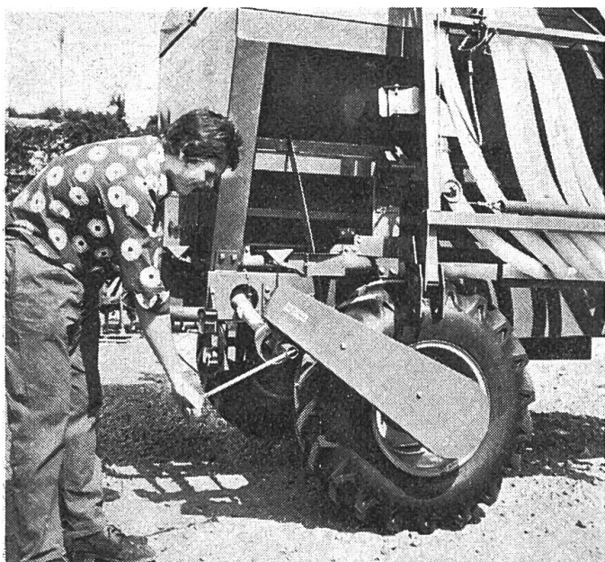
Abb. 2: Voraussetzung der Genauigkeit: Abdrehmöglichkeit des «Jet» — wie bei einer guten Drillmaschine.
