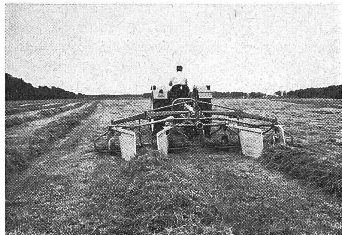
Aus dem **Grünfutterprogramm** sind v. a. folgende Maschinen zu erwähnen: Der bereits bekannte und dieses Jahr in grossen Stückzahlen verkaufte Mäh-knickzetter von PZ / ZWEEGERS sowie als OLMA-NEUHEIT den neu auf dem Markt erschienenen PZ-Super-Strela, mit einer Arbeitsbreite von 5 m, eine Maschine zum Zetten, Streuen, Wenden sowie zum Schwaden.
