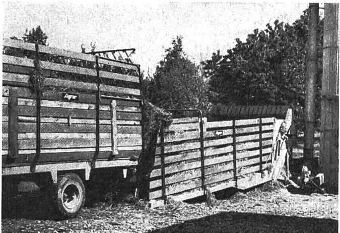
somit die Zufuhr von weiterem Futter, automatisch unterbrochen bis die Futtermenge auf dem Elevator wieder normal ist.
