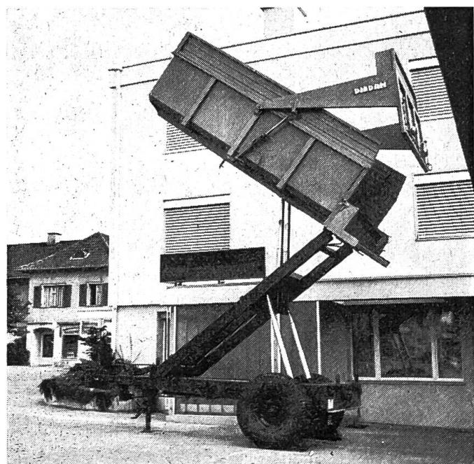
und auch problemloses Umladen von Zuckerrüben auf grössere Fahrzeuge oder Eisenbahn-Waggons. Die Abrutschmenge kann durch eine hydraulisch gesteuerte Heckklappe mit Schüttblech den Anforderungen entsprechend geregelt werden.
