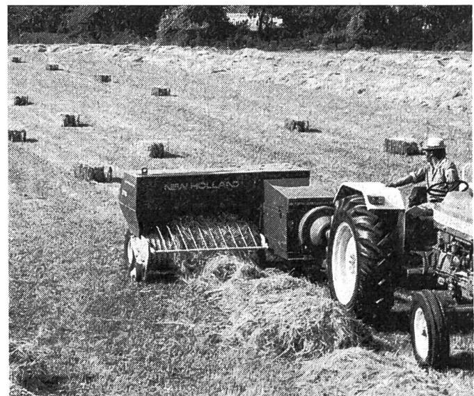
Der Ballenkanal von 36 x 46 cm entspricht den heute handelsüblichen Normen. Die neue Dosierautomatik «Channel-Flow» ist eine Exklusivität von NEW HOLLAND, die das Erntegut gleichmäßig in alle vier Ecken verteilt.
