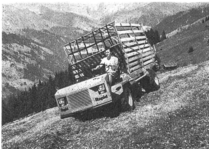
Abb. 4: Selbstfahrladewagen «Cargotrac CC 15-S» mit Lademechanismus zwischen den Achsen im Einsatz; Motorleistung 40 PS. Werkfoto: Fa. Rapid, Maschinen und Fahrzeuge AG, 8953 Dietikon.
