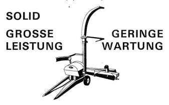
Das grosse Scheibenrad mit 12 Messern und vier grossen Wurfschaufeln gewährleistet einen feinen Exaktschnitt (jedes Korn aufgeschlagen) sowie eine sehr grosse Förderleistung.
