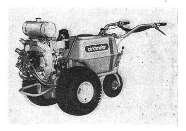
reicht dieses Gerät eine ungeahnte Steigfähigkeit. Das leistungsfähige Gebläse ist mit 8 verstell- und abstellbaren Düsen ausgerüstet, was eine wirtschaftliche und gezielte Spritzarbeit ermöglicht. Für Herbizid-Spritzarbeiten kann mit wenigen Handgriffen ein Spezial-Spritzbalken bis 2 Meter Breite mit 8 Düsen montiert werden.
