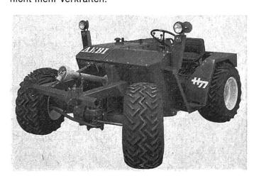
In diese Lücke hinein nun wurde der Hanggeräteträger AEBI Terratrac TT 77 entwickelt. Mit ihm werden auch steilste Hänge für den robusten Rotormäher zugänglich, mit dem man gut und gern Leistungen von 1 ha/h erzielt, weil er auch in schwierigen Verhältnissen nie störanfällig ist.
