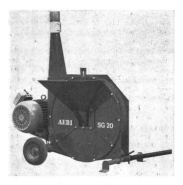
hohe Leistung ein Zapfwellenantrieb vorgesehen. Ein 60-PS-Motor erzielt z.B. Durchsätze von 10 t/h. Auch Körner mit über 45% Feuchtegehalt werden ohne Verstopfung verarbeitet. Das sind Fakten, die den Mäster und den Mähdreschunternehmer aufhorchen lassen. Preis der Maschine für Zapfwellenantrieb 1000 U/min Fr. 4200.—.
