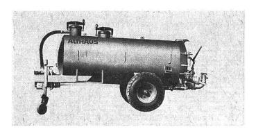
den Fassinhalt in Zirkulation. Die Rührwirkung der Schnecke ist gegenüber bisherigen Luft- oder Flügelrührwerken geradezu verblüffend. Selbst dickflüssige Stoffe oder Jauche aus Schweine- und Geflügelmästereien werden garantiert restlos und sauber aus dem Fass herausgespült.
