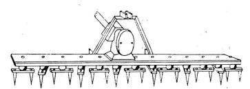
Abb. 4: Kreiselegge mit horizonalen rotierenden Zinken, Arbeitsbreite 1–6 m (Dreipunktgerät). Es können verschiedene Zinkenformen und -längen gewählt werden.
