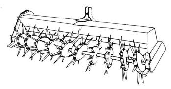
Abb. 5: Taumelwälzeggen. Hier rollen die Werkzeugsterne durch die Vorwärtsbewegung des Gerätes am Boden ab.
