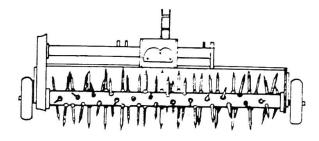
Abb. 2: Zinkenrotor (Dreipunktgerät), Arbeitsbreite 180-450 cm, Leistungsbedarf 20-110 PS.
