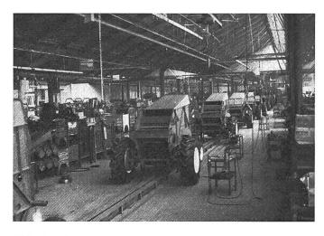
Abb. 2: Eine grosszügig angelegte Fertigungsstrasse erlaubt die Produktion von ca. 4000 Fahr-Mähdreschern pro Jahr. Die Fertigung erfolgt in den ehemaligen Werkhallen der Fa. Ködel und Böhm.
