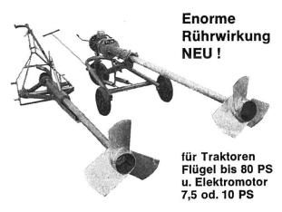
Mit 3-Rad-Fahrgestell und mechanischer Hebe- und Senkvorrichtung. Müheloses Senken und Heben des Rührwerks auch bei kleinen Grubenlöchern. Wenn es mit anderen Systemen nur mühsam oder gar nicht möglich ist, geht es mit dem neuen Fahrgestell rei-bungslos. Sofern nicht auf die Grube gefahren werden kann, ist es von der Seite einsetzbar.
