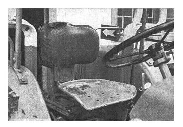
Abb. 4: Zu hoher Verschleiss an einem serienmässigen Traktorfahrersitz (Polsterung ganz zerstört).
