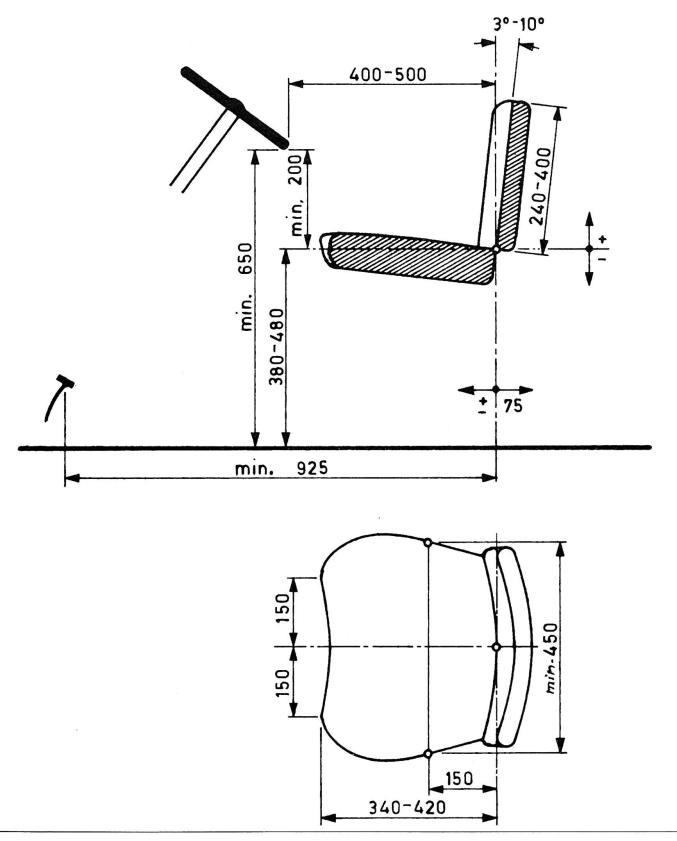
Abb. 5: Sitz- und Bedienungsteilanordnung bei Traktoren. (Die angegebenen Masse in mm gelten für den belasteten Sitz bei einer Sitzeinsenkung von 50% des gesamten Schwingweges, wobei der Sitz sich in seiner Mittelstellung befindet.)
