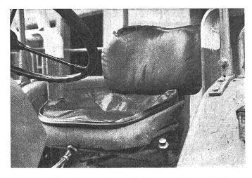
Abb. 3: Frühzeitiger Verschleiss an einem Traktorfahrersitz. Nach 1600 Betriebsstunden (Foto FAT).
