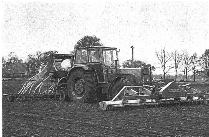
Die Fronthydraulik und Frontzapfwelle am Favorit 612 S ermöglichen wirtschaftliche Kombinationen bei Bestellarbeiten, wie hier bei der 6 m breiten Rüttel-egge und der 6 m breiten Grosssämaschine.
