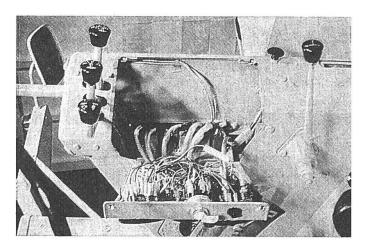
Abb. 4 Vorbildliche Gestaltung des Armaturenbrettes eines Mähdreschers. Alle elektrischen Anschlüsse sind als Steckkontakte ausgebildet und liegen nach Aufklappen des Instrumententrägers frei.
