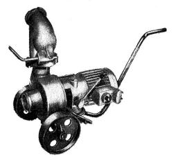
Vertikalpumpen Leistung 800 Liter pro Minute rostfrei mit Motor, Rührwerk und Auslaufrohr Fr. 1130.—.
