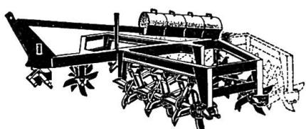
Spatenkrümler, 2- oder 3-reihig, mit 2, 4 oder 6 Walzen, Arbeitsbreiten von 1,67 bis 2,60 m
