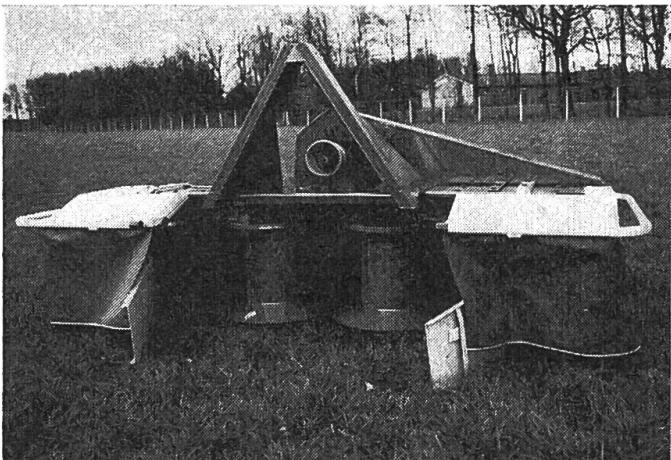
bar für links- oder rechtsdrehende Zapfwelle mit 540 oder 1000 U/min. und ist für die Geräteschnellkuppelung Weiste-ACCORD ausgerüstet.
