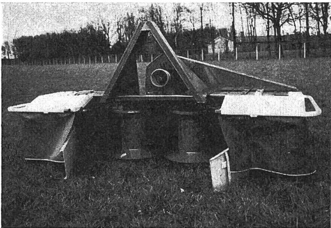
bar für links- oder rechtsdrehende Zapfwelle mit 540 oder 1000 U/min. und ist für die Geräteschnellkuppelung Weiste-ACCORD ausgerüstet.
