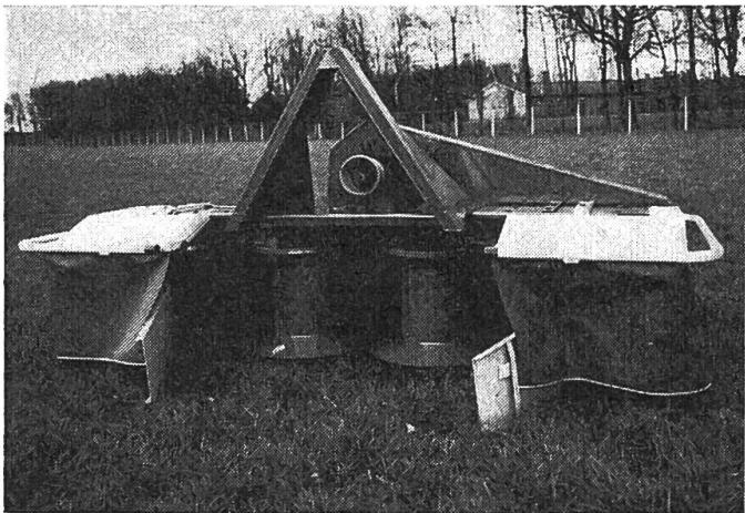
bar für links- oder rechtsdrehende Zapfwelle mit 540 oder 1000 U/min. und ist für die Geräteschnellkupplung Weiste-ACCORD ausgerüstet.
