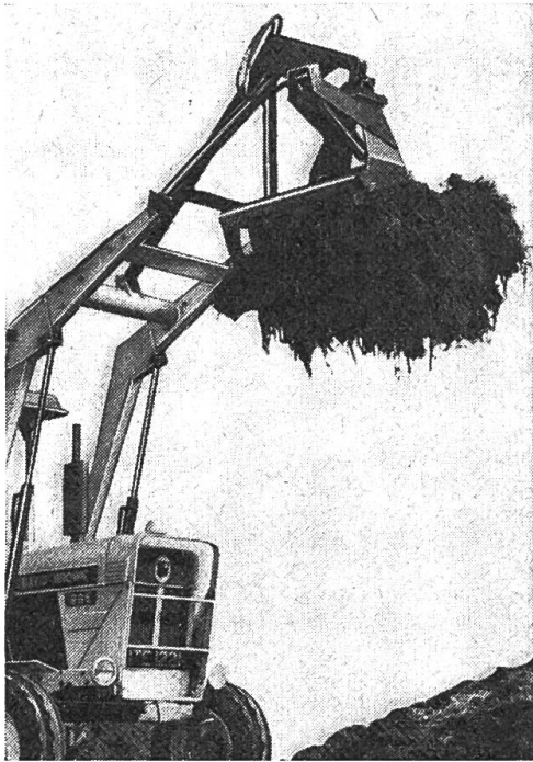
Abb. 6: Neu entwickelte Geräte machen den Frontlader noch universeller. Dieser hydraulische Greifer stellt eine solche Entwicklung dar.
