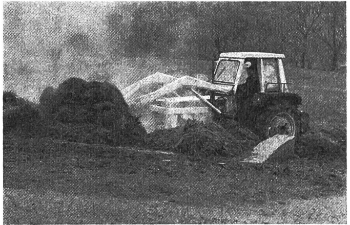
Abb. 2: Traktor mit Schnellwechselfrontlader. Der Abbau des ganzen Aggregates geschieht gemäss Abb. 3.
