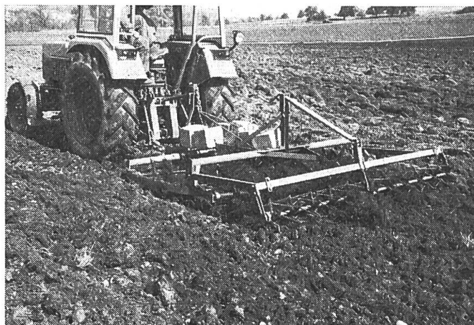
Abb. 8: Die Ausrüstung der Spatenrolleggen mit einer Krümlerwalze trägt zu einer wesentlichen Verbesserung der Saatbettqualität bei.
