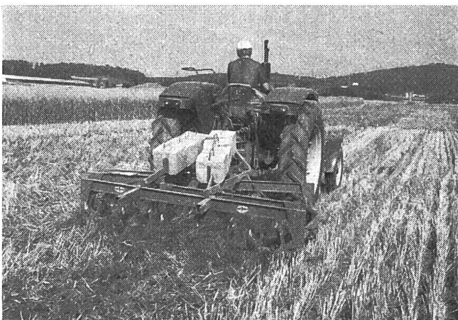
Abb. 5: Bei der Stoppelbearbeitung ist eine starke Belastung der Egge angezeigt; der zweite Durchgang soll möglichst «übers Kreuz» oder diagonal vorgenommen werden.
