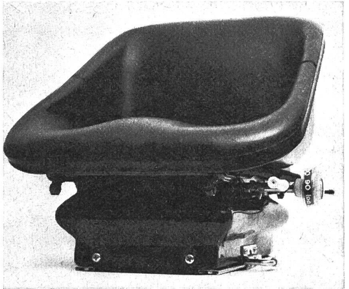
DERBY-Hydraulikstuhl GI 5000-302, ein Spezialstuhl mit Lkw-Komfort für alle Fahrzeuge im Agrarbereich.
