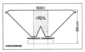
Zweischeibenstreuer ermöglichen gegenüber Einscheibenbauart zusätzlichen Behälterinhalt (schraffiert). Dadurch kann bei Flachbauweise die Wandniegung noch so steil bleiben, dass alle gekörnten und kristallinen Sorten sicher nachrutschen.
