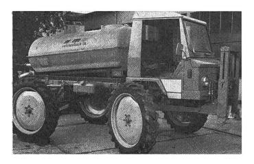
Portalachsen, Räder, weitere Kraftheber und Bedienungseinrichtungen ergänzt wurde.
