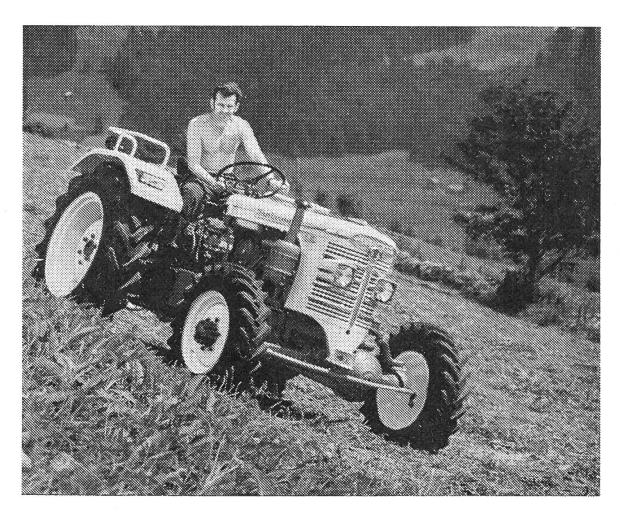
45 DIN 50 SAE PS am Motor, 40 DIN 44 SAE PS an der Zapfwelle Standard-Getriebe mit 12 Gängen, Zapfwelle 540+1050 Touren Wegzapfwelle Regel-Hydraulik mit 2 zusätzlichen Steuerventilen Hydraulikpumpe BOSCH (Fördermenge 32 I/min. 150 atü)
