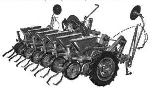
**Vielfachgeräte** 2–4-reihig, mit halbautomatischen Setzmaschinen, Hackgruppen, Kammjäter, Rübenhackwerkzeug, Spiro-Zinken (Tiefgrubber) usw.
