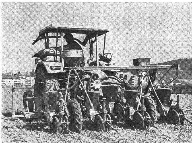
Abb. 31: Mais-Einzelkornsaat mit gleichzeitiger Ausbringung von Insektizid-Granulat. Das Granulat wird nahe an die Maiskörner abgelegt. (Einsatzversuch mit zwei verschiedenen Granulatstreuern.)
