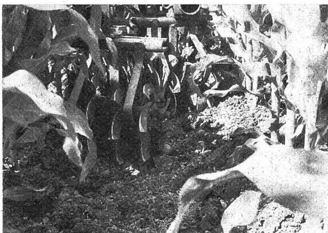
Abb. 29: Für die Hirsenbekämpfung im Mais hat sich das Sternhackgerät gut bewährt. Bei Schrägstellung der Arbeitswerkzeuge wird eine Häufelwirkung erzielt und dadurch die in der Reihe wachsenden Unkräuter zugedeckt.
