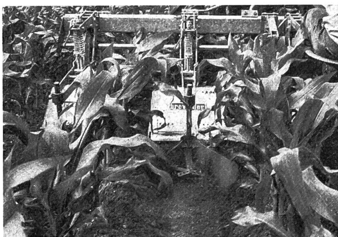
Abb. 30: Mit einer zapfwellengetriebenen Reihenfräse mit Häufelkörper lässt sich ebenfalls eine wirksame Unkrautbekämpfung erreichen.
