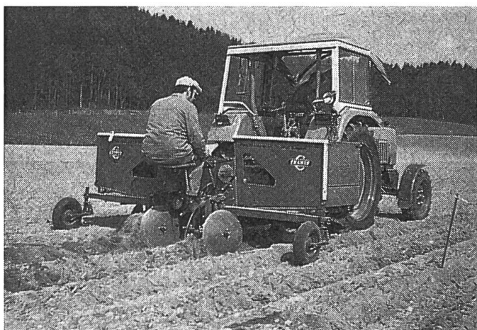
Abb. 24: Zweireihiger Vierfachbecher-Legeautomat. Die Regelung der rollbodenartigen Zufuhrorgane erfordern eine Bedienungsperson.
