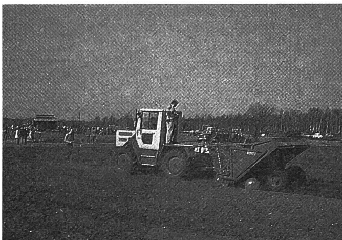
Abb. 26: Tagesleistungen von zirka 7 bis 9 ha können mit den Bunkerlegemaschinen bewältigt werden. Das Legen von vorgekeimten Kartoffeln ist allerdings mit diesem Verfahren noch nicht befriedigend gelöst.
