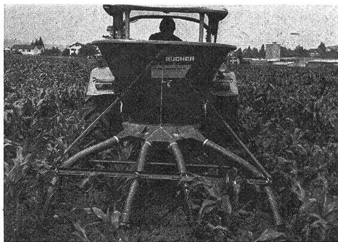
Abb. 18: Zweiseiben-Schleuderstreuer mit vierreihiger Reihenstreuervorrichtung bei Mais-Unterblatt-düngung.
