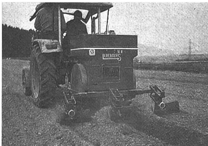
Abb. 25: Greiferrad-Legeautomat. Die elektrische Fehlstellenanzeige ermöglicht dem Traktorführer eine bequeme Funktionskontrolle.
