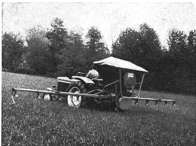
Abb. 19: Pneumatisch-mechanischer Düngerstreuer mit 9 m Arbeitsbreite bei der Kopfdüngung. Ausser für gekörnte und kristalline Dünger kann der Streuer nach Ausrüstung mit einer Feindosierwalze auch für Mikrogranulate eingesetzt werden.
