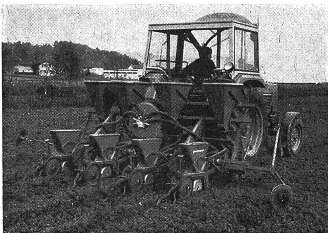
Abb. 21: Pneumatische Einzelkornsämaschine bei Maissaat mit gleichzeitiger Unterfussdüngung. Der Dünger wird 5 cm neben der Saatreihe und auf einer Tiefe von 10 bis 12 cm abgelegt.
