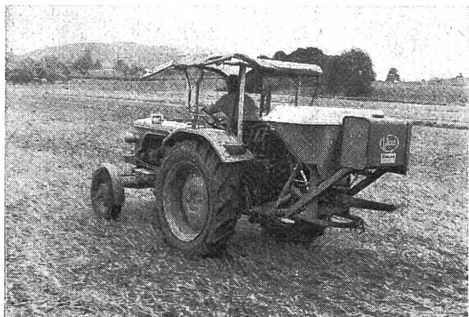
Abb. 17: Pendelstreuer mit Anfeuchtgerät beim Ausbringen von Thomasmehl. Bei diesem System wird der Dünger erst im Pendelrohr angefeuchtet.
