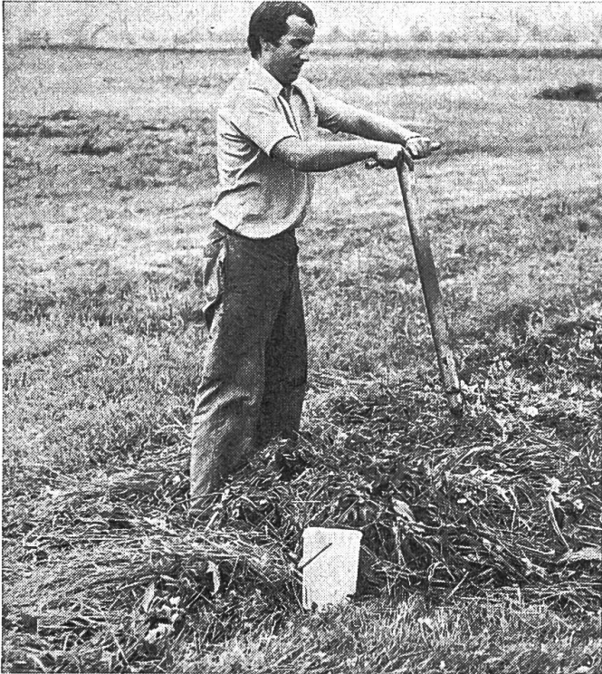
Abb. 4: Probeentnahme zur Trockensubstanz- und Schmutzbestimmung.
