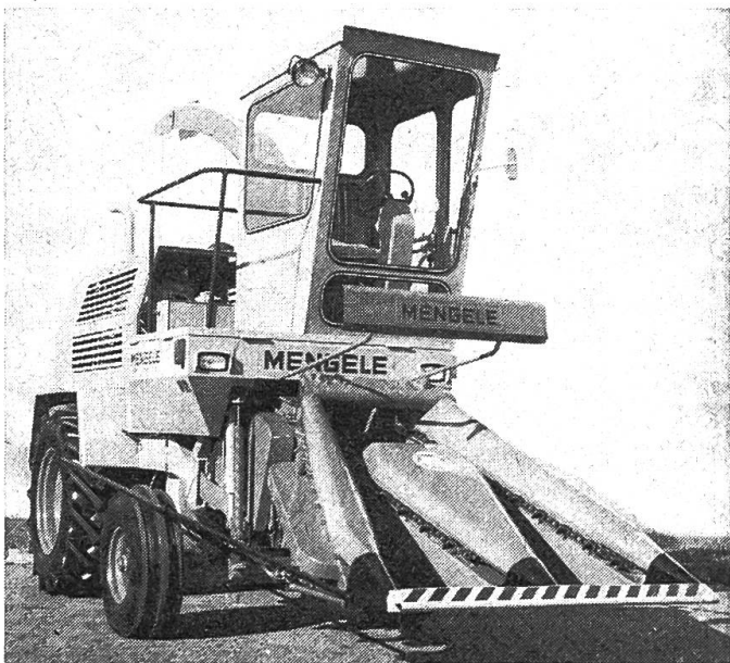
Abb. 6: Selbstfahr-Feldhäcksler SF 2000 (Werkbild: Mengele & Söhne)
