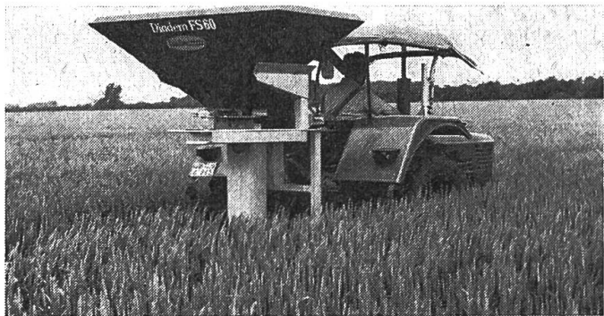
Abb. 3: Diadem Schleuderdüngerstreuer (Werkbild: H. W. Dreyer)
