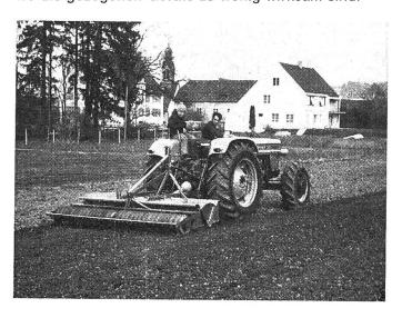
Für schwere Böden, die sich mit den gezogenen Geräten nicht gut bearbeiten lassen, stehen zapfwellengetriebene Kreiseleggen und Bodenfräsen zur Verfügung. Die Ausrüstung dieser Eggen mit einer Krümlerwalze erwies sich als vorteilhaft. Die Walze bestimmt die Arbeitstiefe und verdichtet gleichzeitig den gelockerten Boden (Abb. 10 und 11). Für den Antrieb der erwähnten Eggen wird eine Traktorleistung von zirka 20 bis 35 PS je m Arbeitsbreite benötigt.
