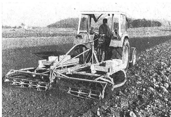
Abb. 9: Eine Spatenrollegge eignet sich, dank der Misch- und Tiefenwirkung der Spaten, insbesondere zur Saatbettherstellung auf frischen Aeckern und für die Stoppelbearbeitung. Ihre Arbeitsintensität kann durch die Zusatzgewichte und Krümlerwalze sowie beim Struchen durch einen vorgängigen Tiefgrubber-einsatz erhöht werden.
