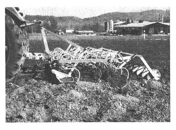
Abb. 8: Für die Herstellung eines tieferen Saatbettes, zum Beispiel für Kartoffeln, wird der Kultivator verwendet. Der Planierschild vorne ebnet den Acker und zerdrückt gleichzeitig die Schollen.
