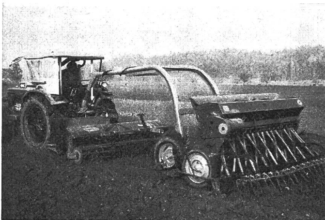
Abb. 13 und 14: Beim Verfahren «Bestellsaat» werden die konventionellen Geräte zusammengekuppelt und die Bestellarbeiten in einem Arbeitsgang durchgeführt. Durch die Verwendung eines Spezial-Geräteträgers wird die Wirtschaftlichkeit dieses Verfahrens stark beeinträchtigt.
