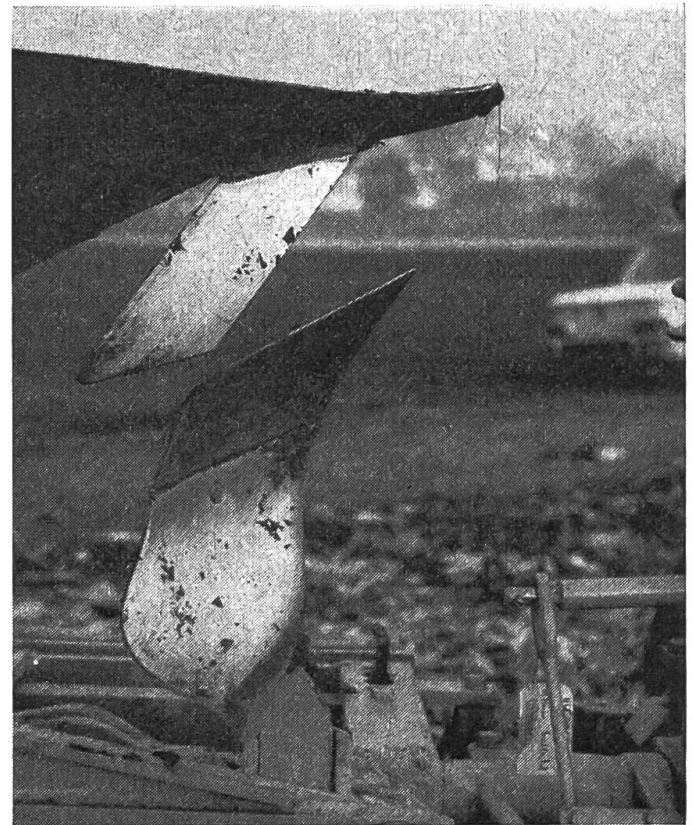
Abb.5 und 6: Die Feinzerkleinerung von Getreide- und Maisstroh ist für die nachfolgenden Bestellarbeiten unentbehrlich. Ein Spezialvorschäler und ein Kurzsech erleichtern das Unterpflügen von Stroh wesentlich (Abb. 6).
