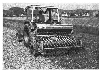
Abb. 12: Die pfluglose Frässaat, für die eine Frässämaschine benützt wird, bewährte sich insbesondere für den Zwischenfutterbau (Abb.) und für den Weizenbau nach Hackfrüchten und Mais.
