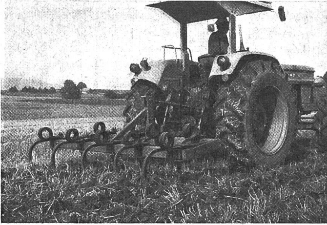
Abb.3 und 4: Die Tiefgrubber mit gefederten oder starren Zinken eignen sich für die Bodenlockerung bis 35 cm Tiefe. Oft ist ein Nachgang einer Spatenrollegge für die Beseitigung der grobscholligen Struktur erforderlich.
