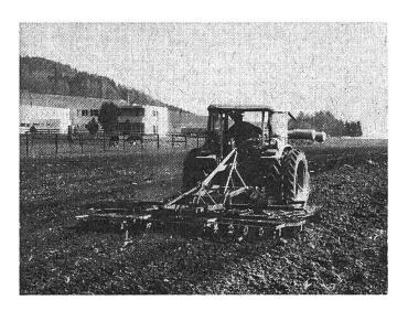
Abb. 7: Eine Löffelegge ermöglicht dank gänsefussartiger Zinkenform eine flache und gleichzeitig gründliche Oberflächenbearbeitung. Sie eignet sich besonders gut für die Saatbettvorbereitung für Zukkerrüben.
