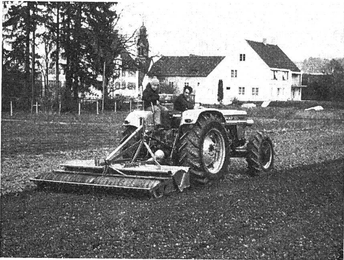
Abb. 10 und 11: Zapfwellengetriebene Kreiseleggen und Bodenfräsen sind vor allem dort zu verwenden, wo die gezogenen Geräte zu wenig wirksam sind.
