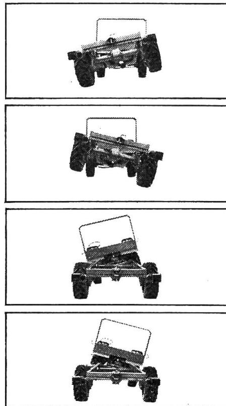
Er wird bewundert, wo immer er auftaucht, der neue SCHILTER 1800. Was man ihm aber nicht auf den ersten Blick ansieht, das ist seine extra-grosse Überlastsicherheit. Er verdankt sie dem Zwillingschassis. Diese patentierte SCHILTER-Spezialkonstruktion ist viel stärker als der bei Transportern sonst übliche Zentralrohrrahmen. Zwei massive Chassisrahmen greifen ineinander und erlauben ein starkes Verdrehen. Das bedeutet: erheblich verminderte Kippgefahr im Vergleich zu jeder andern Konstruktion.
