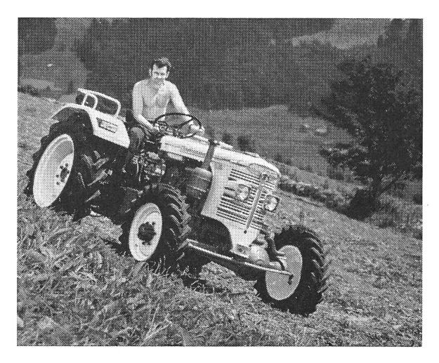
45 DIN 50 SAE PS am Motor, 40 DIN 44 SAE PS an der Zapfwelle Standard-Getriebe mit 12 Gängen, Zapfwelle  $540 \pm 1050$  Touren Wegzapfwelle
