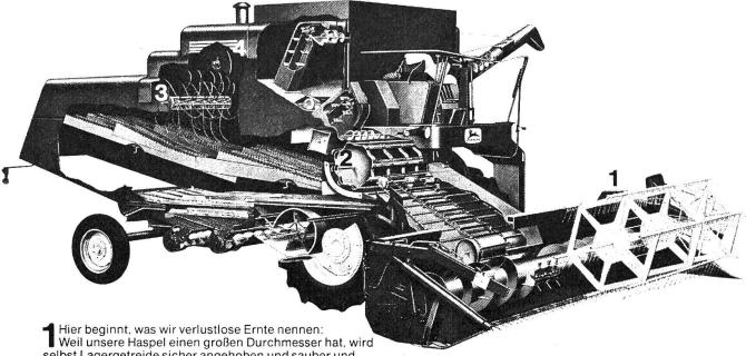
Weil unsere Haspel einen großen Durchmesser hat, wird selbst Lagergetreide sicher angehoben und sauber und gleichmäßig zum Messer und zur Querförderschnecke transportiert. Durch Schnellkupplung am Schrägförderer, der fest mit dem Mähdrescher verbunden ist, können Sie einfach und schnell vom Schneidwerk auf Maispflückvorsätze – oder umgekehrt – wechseln.
