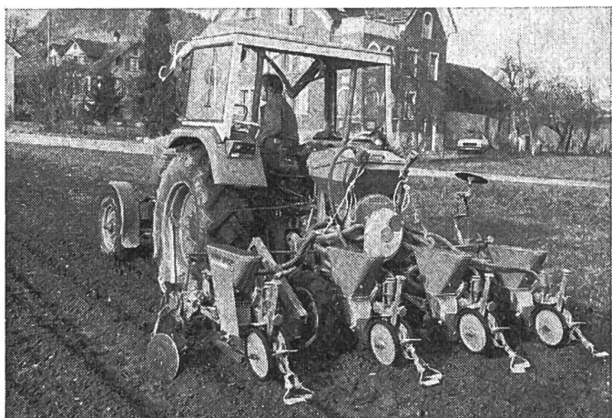
Abb.7: Granulatstreuer Nodet bei der Ausbringung von Curaterr, fünfter und sechster Streuschlauch am Hauptbehälter angeschlossen (bei Dyfonate musste hingegen für die übrigen zwei Streuschläuche unten ein Zusatzbehälter angebracht werden).
